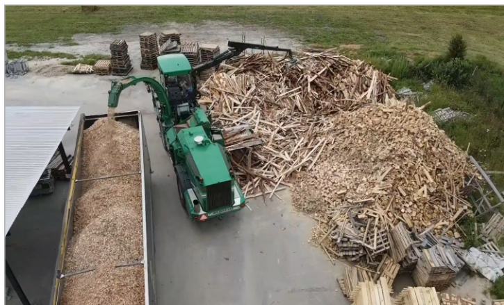
Odpady tartaczne są rębakowane w celu dostosowania do podajników w przemysłowych piecach
