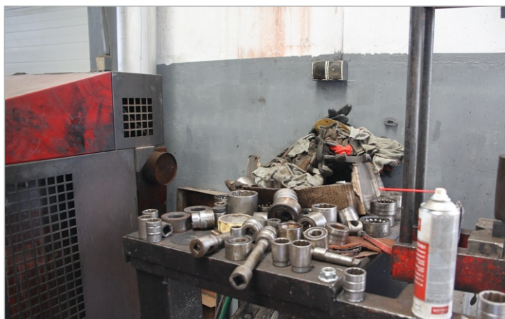
Zużyte czyściwo, narzędzia oraz zużyte części na jednym warsztacie a obok urządzenie grzewcze - brak gospodarki odpadami w tym przypadku stwarza niebezpieczeństwo wystąpienia pożaru
